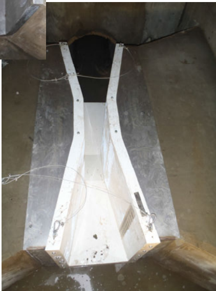
Speciale uitvoering voor een verplaatsbare Parshall meetkanaal
