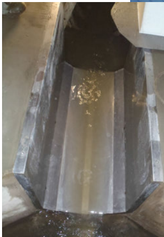
Speciale uitvoering voor een verplaatsbare Parshall meetkanaal
